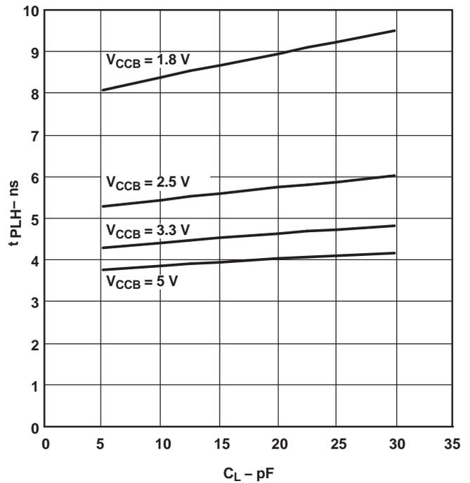
TYPICAL PROPAGATION DELAY (B to A) vs LOAD CAPACITANCE
