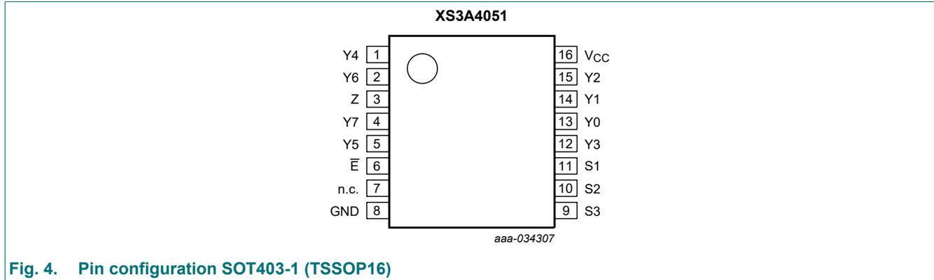
Fig. 4. Pin configuration SOT403-1 (TSSOP16)
