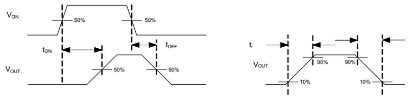
**Figure 21.  $T_{ON}/T_{OFF}$  Waveforms**
