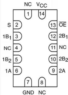
Figure 3. DQFN (Top Through View)
