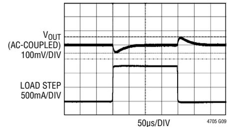
V<sub>IN</sub> = 12V, V<sub>OUT</sub> = 3.3V, f<sub>SW</sub> = 1MHz
