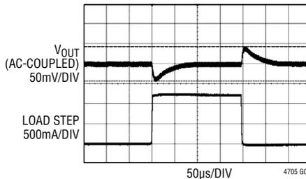
V<sub>IN</sub> = 12V, V<sub>OUT</sub> = 2.5V, f<sub>SW</sub> = 1MHz
