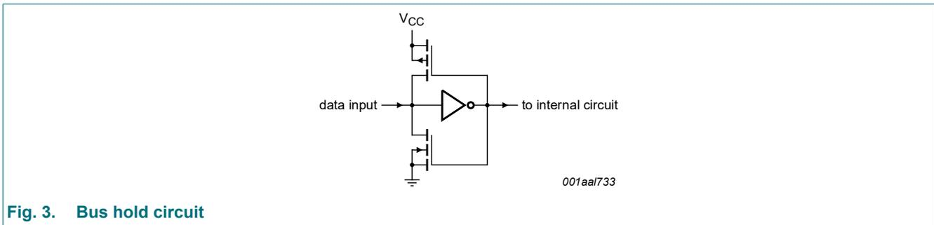
Fig. 3. Bus hold circuit
