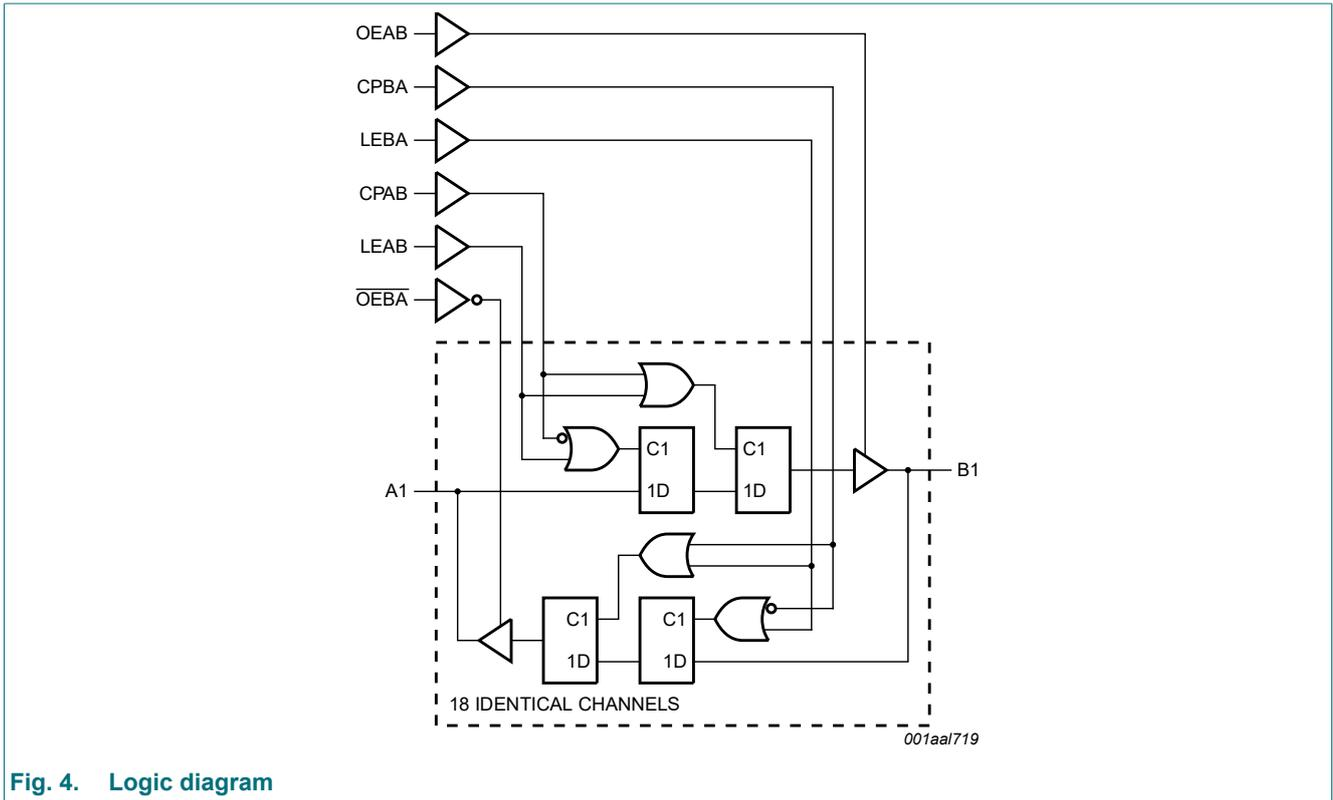
Fig. 4. Logic diagram
