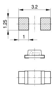
Bauteil positioniert Component location on pad OHFP2578
