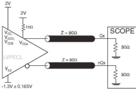
**3.3V OUTPUT LOAD AC TEST CIRCUIT**
