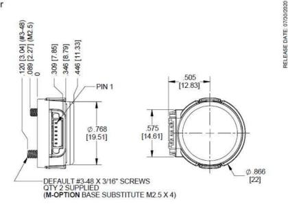
H-OPTION COVER (COVER HOLE FOR EXTENDED SHAFTS)
