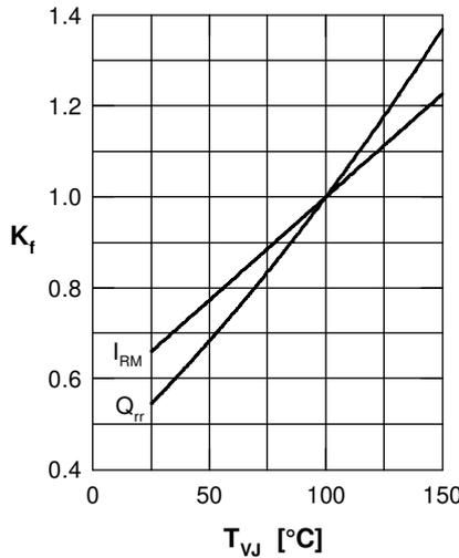
Fig. 4 Typ. dyn. parameters  $Q_r, I_{RM}$  versus  $T_{VJ}$
