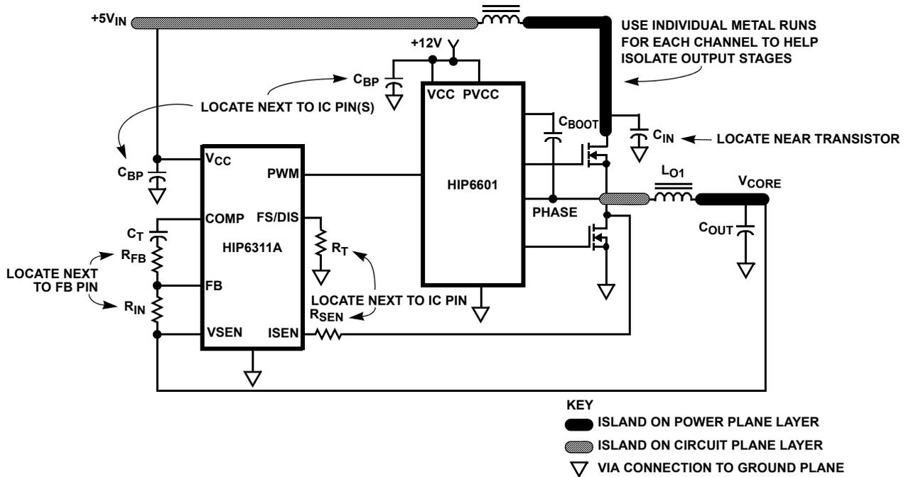
FIGURE 11. PRINTED CIRCUIT BOARD POWER PLANES AND ISLANDS
