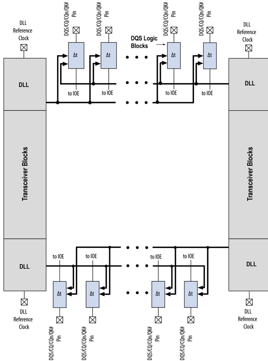
Figure 7-5: DQS/CQ/CQn/QK# Pins and DLLs in Arria V SX and ST Devices
