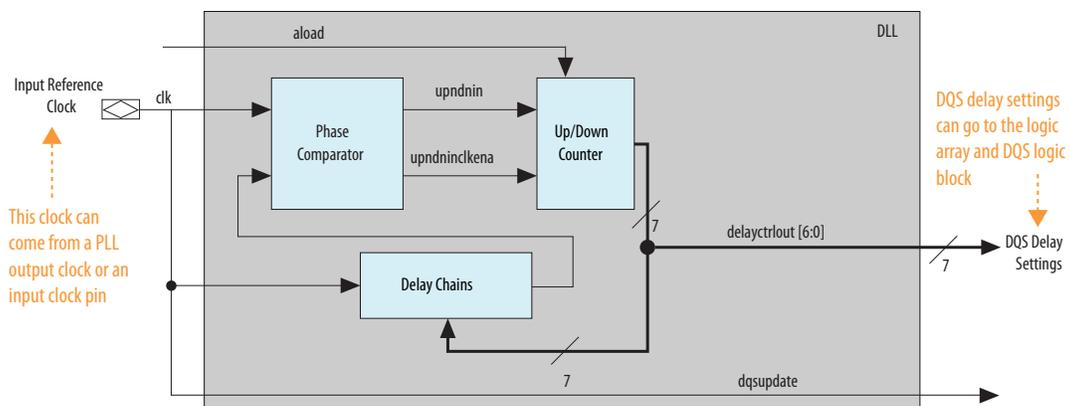
**Figure 7-7: Simplified Diagram of the DQS Phase-Shift Circuitry (Arria V GZ)**
