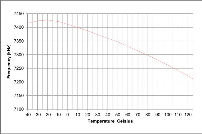
**FIGURE 26-14: TYPICAL LPRC FREQUENCY @ VDD = 3.3V**
