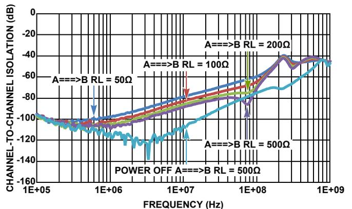
FIGURE 19. CHANNEL-TO-CHANNEL ISOLATION
