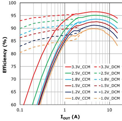
Figure 22: 5V<sub>IN</sub>, 600kHz, 0.47µH
