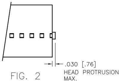
FIG. 2 HEAD PROTRUSION MAX.
