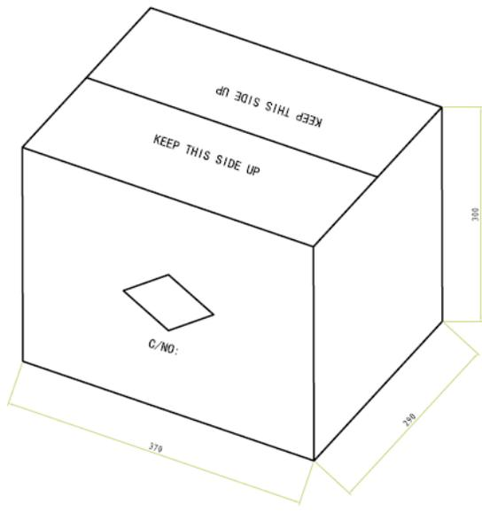
1. Package Box : L=370mm; W=290; H=300mm;
