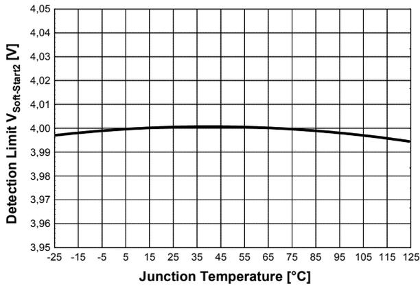
Figure 42 Detection Limit  $V_{Soft-Start2}$  vs.  $T_j$
