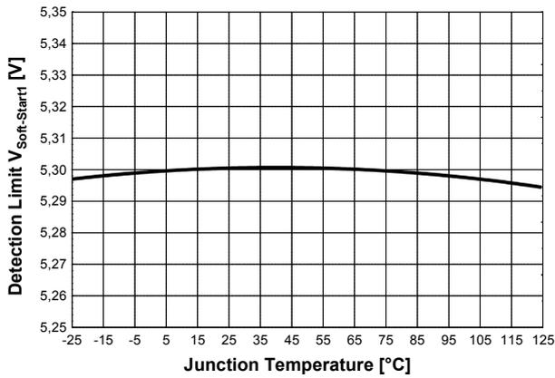
Figure 41 Detection Limit  $V_{Soft-Start1}$  vs.  $T_j$
