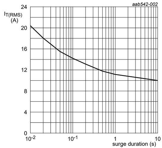
$f = 50\text{ Hz}$ ;  $T_h = 95\text{ }^\circ\text{C}$
