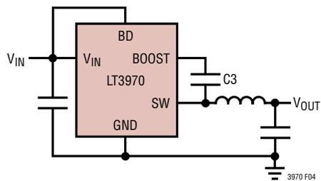
(4b) For  $V_{OUT} < 2.2V$ ;  $V_{IN} < 27V$
