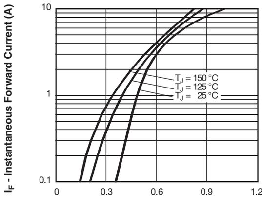
93279\_01 **V<sub>FM</sub> - Forward Voltage Drop (V)**
