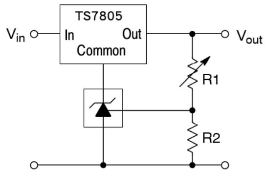
$$V_{out} = \left(1 + \frac{R1}{R2}\right) V_{ref}$$
