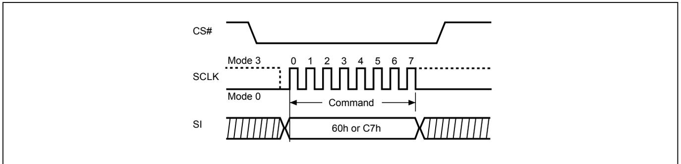
**Figure 87. Chip Erase (CE) Sequence (QPI Mode)**
