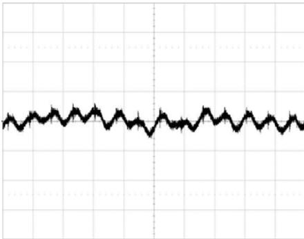
Output voltage ripple (5 mV/div.) at:
