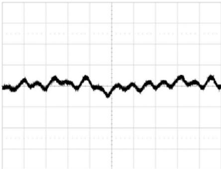
Output voltage ripple (5 mV/div.) at:
