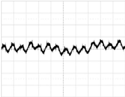
Output voltage ripple (5 mV/div.) at:
