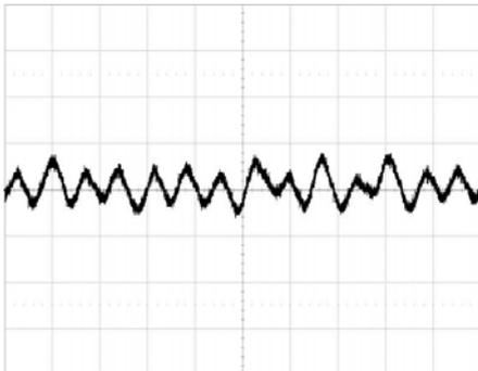
Output voltage ripple (5 mV/div.) at:
