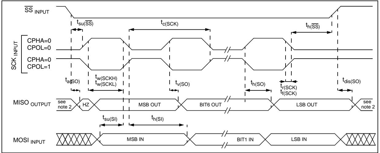
Figure 95. SPI Master Timing Diagram <sup>1)</sup>
