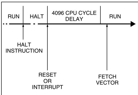
**Figure 26. HALT Mode Flowchart**
