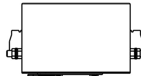
DIN RAIL CHANNEL      DIN 35 BRACKET
