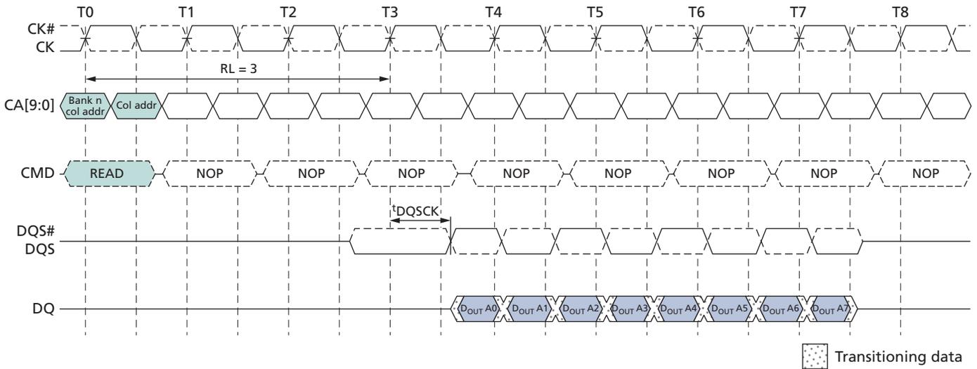
**Figure 16:  $t_{DQSKDL}$  Timing**
