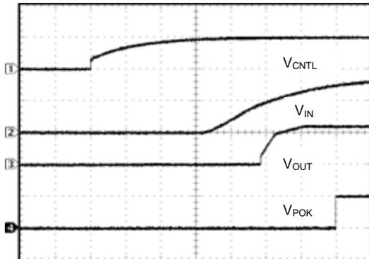
$C_{OUT}=10\mu F$ ,  $C_{IN}=10\mu F$ ,  $R_L=0.4\Omega$
