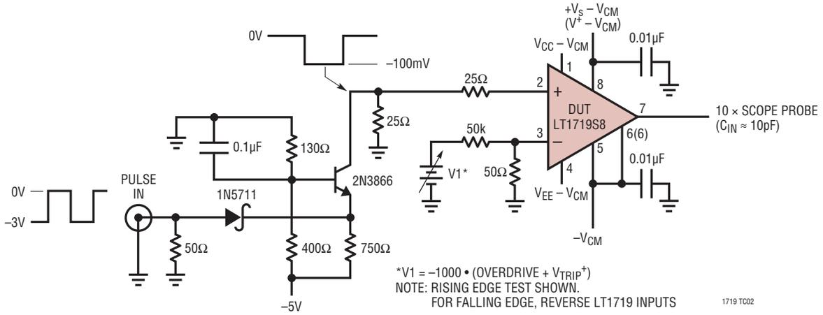
$\pm V_{\text{TRIP}}$  Test Circuit
