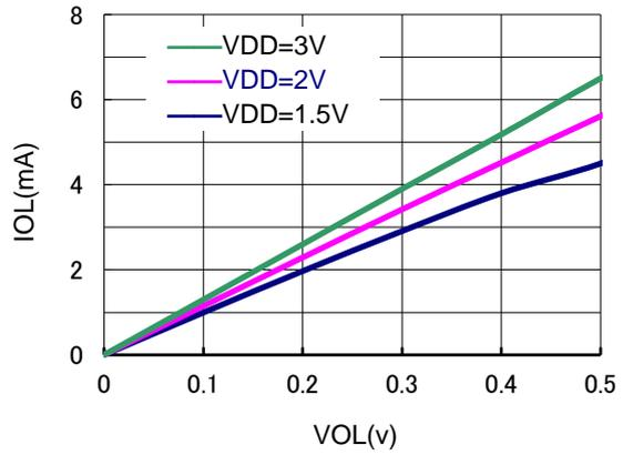
$V_{OL}$  vs  $I_{OL}$
