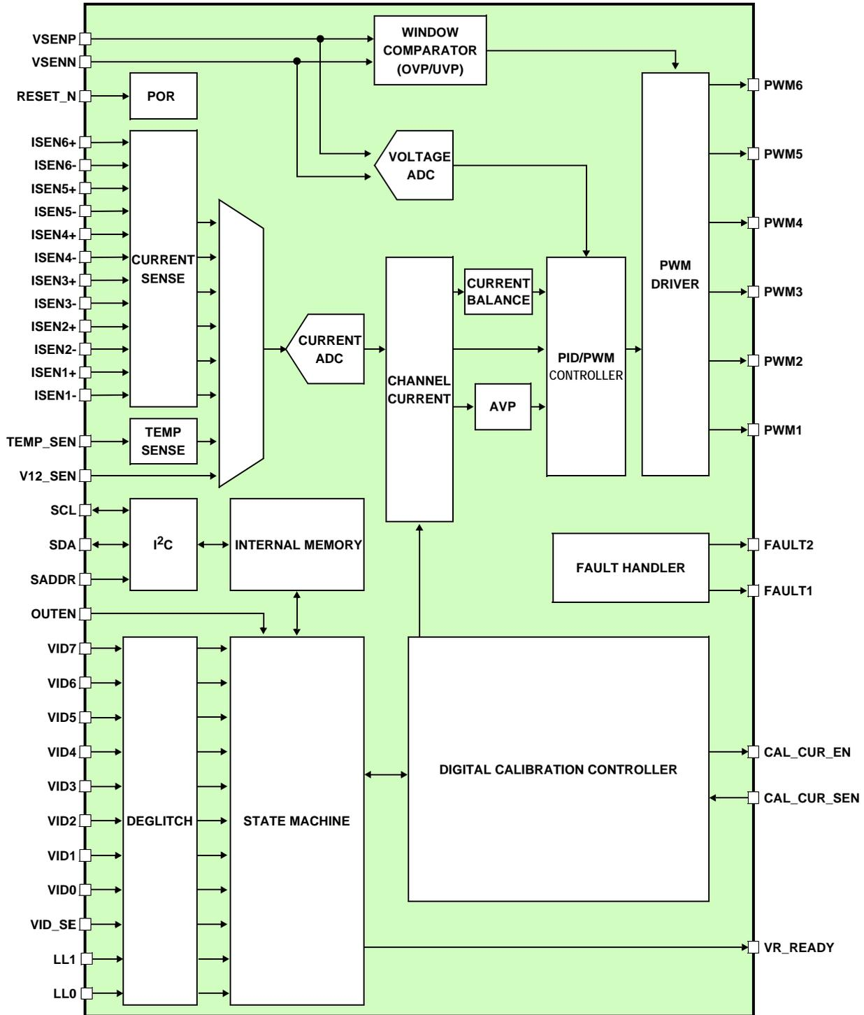
FIGURE 1. BLOCK DIAGRAM FOR DIFFERENTIAL I-SENSE, PWM-ONLY OUTPUT
