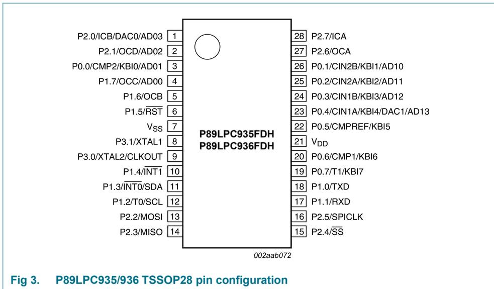
**Fig 3. P89LPC935/936 TSSOP28 pin configuration**
