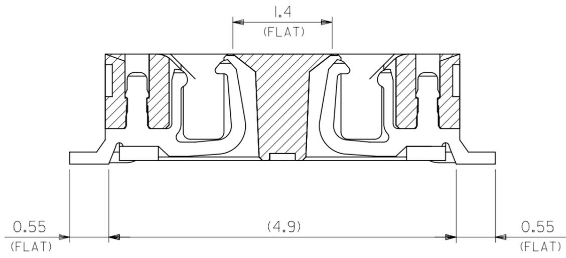
製品断面図 (半田付け部、吸着面寸法)
