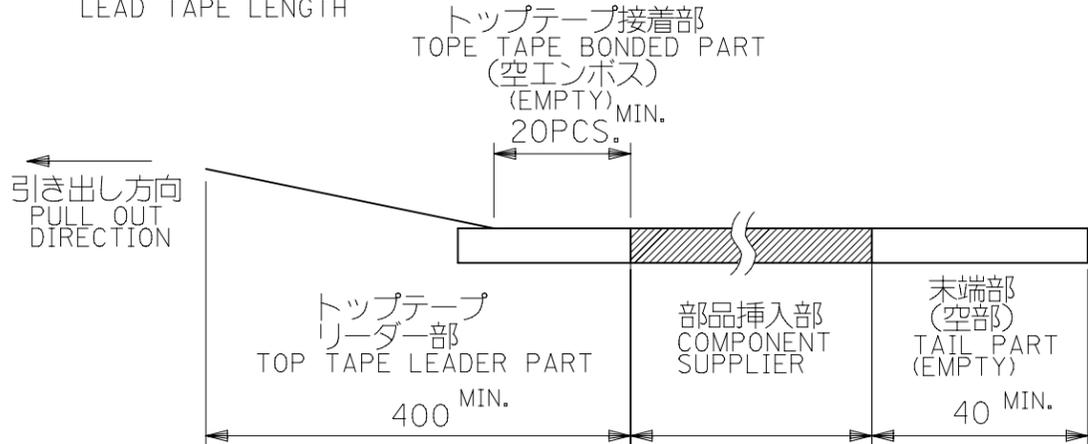
4. トップテープの剥離強度：(剥離方向は下図参照)
