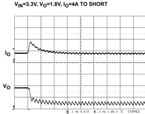
**FIGURE 21. SHORT-CIRCUIT PROTECTION**
