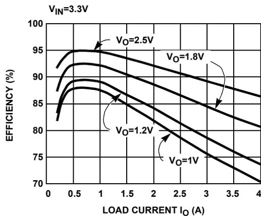
FIGURE 1. EL7563CM EFFICIENCY vs I<sub>O</sub>
