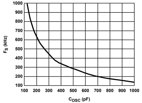
FIGURE 12. SWITCHING FREQUENCY vs C<sub>OSC</sub>
