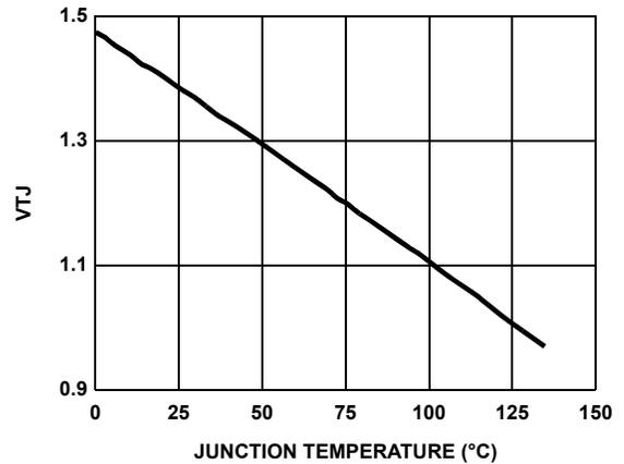
FIGURE 14. VT<sub>J</sub> vs JUNCTION TEMPERATURE
