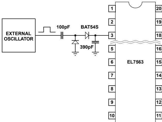
FIGURE 22. OSCILLATOR SYNCHRONIZATION
