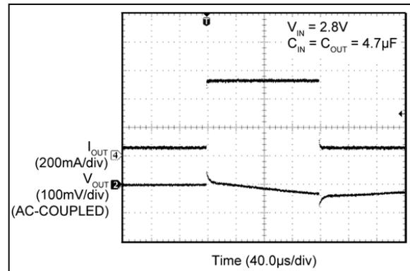
**FIGURE 2-17:** Load Transient.
