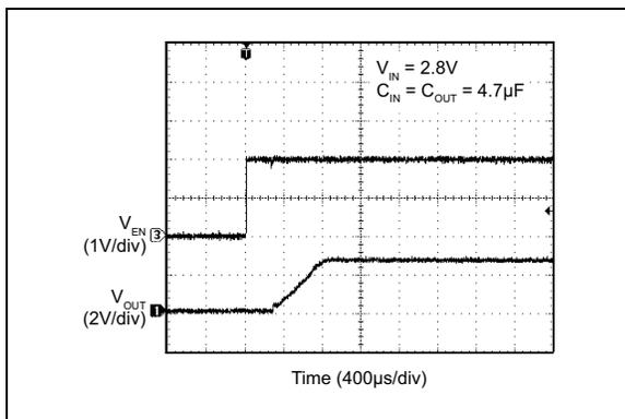
**FIGURE 2-20:** *Enable Turn-On.*
