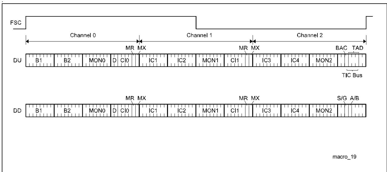
**Figure 10 IOM<sup>®</sup>-2 Frame Structure of the T-SMINT<sup>®</sup>I**
