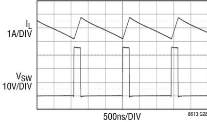
36V<sub>IN</sub> TO 5V<sub>OUT</sub> AT 2A
