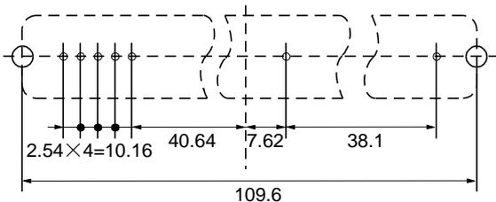
7—  $\circ$  Diameter :  $\phi$  1.2      2—  $\bigcirc$  Diameter :  $\phi$  2.5
