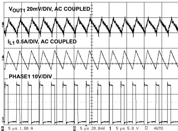
FIGURE 5. PWM1 WAVEFORMS
