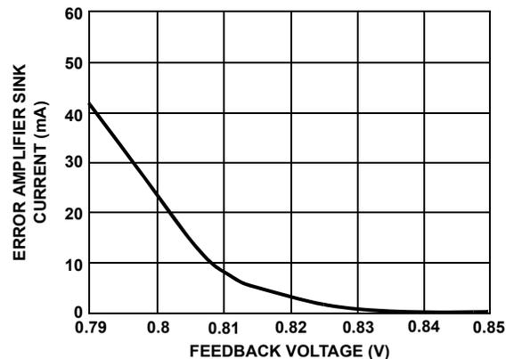
FIGURE 19. LINEAR CONTROLLER GAIN
