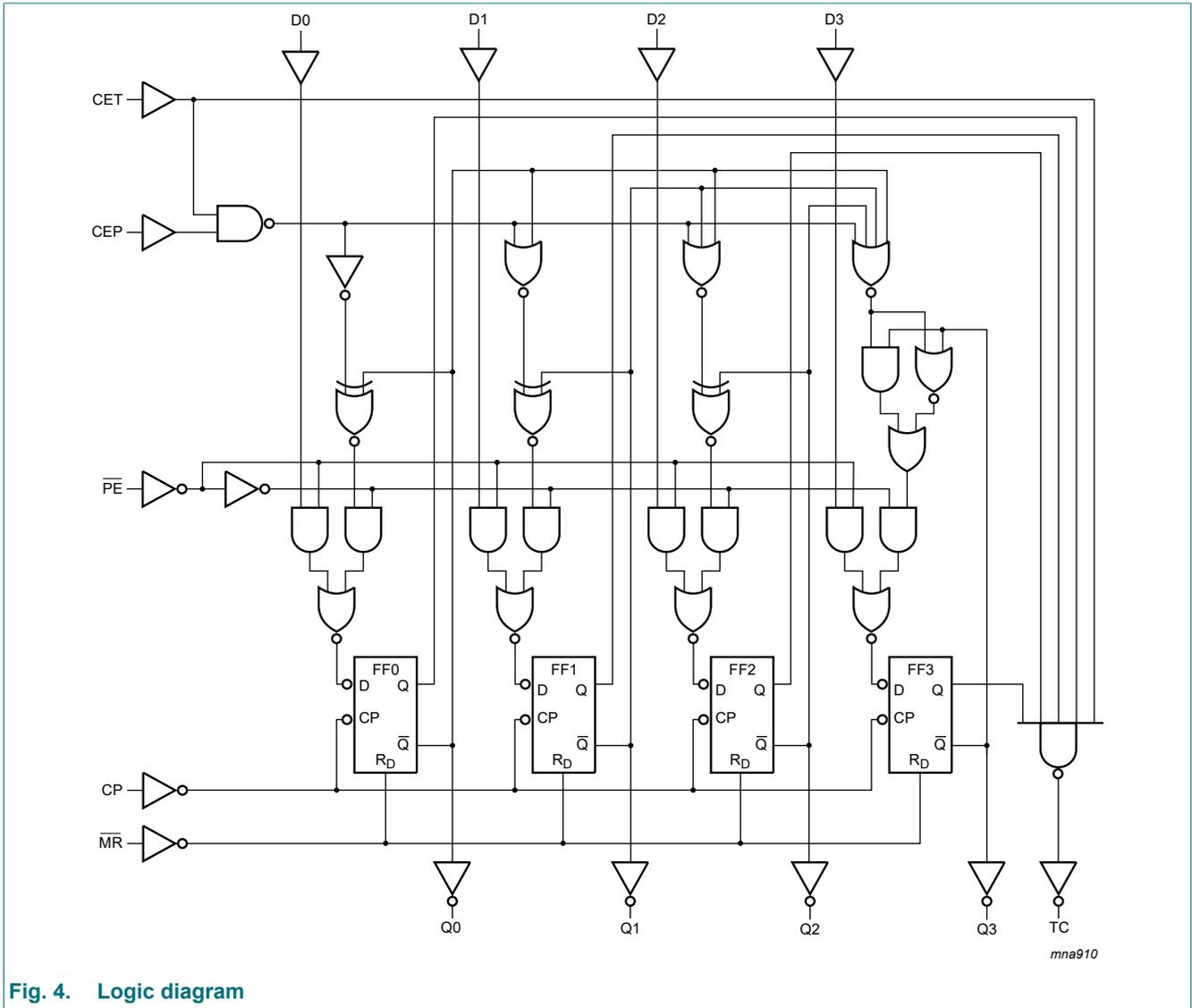
Fig. 4. Logic diagram
