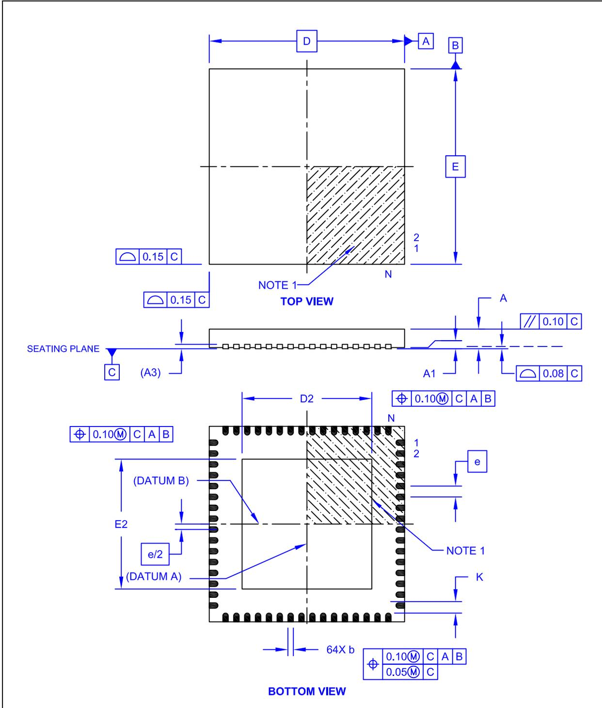
**FIGURE 20-2: 64-QFN PACKAGE DIMENSIONS**
