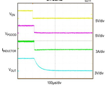
STEADY STATE SWITCHING WAVEFORM
