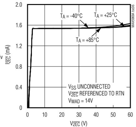
**PG SINK CURRENT vs. PG VOLTAGE**
