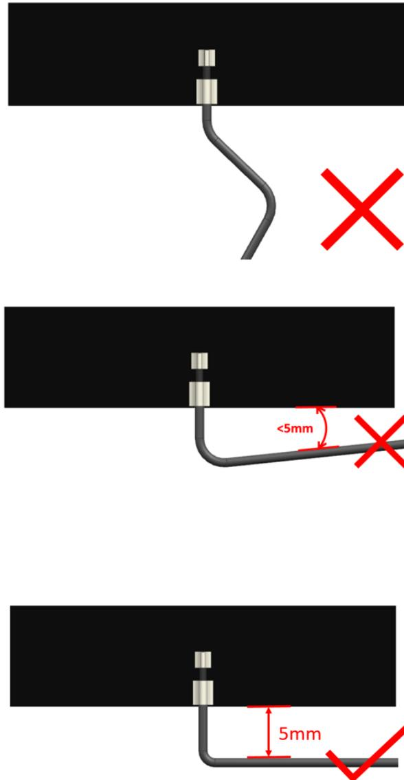
FIGURE 5.2.1 CABLE BENDING
