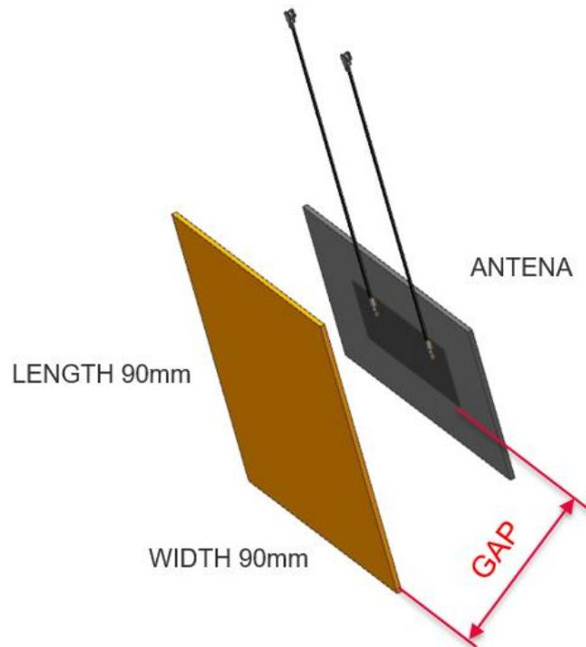
**FIGURE 6.1.0 FOUR LOCATIONS WITH PARALLEL PLANE GROUND**
