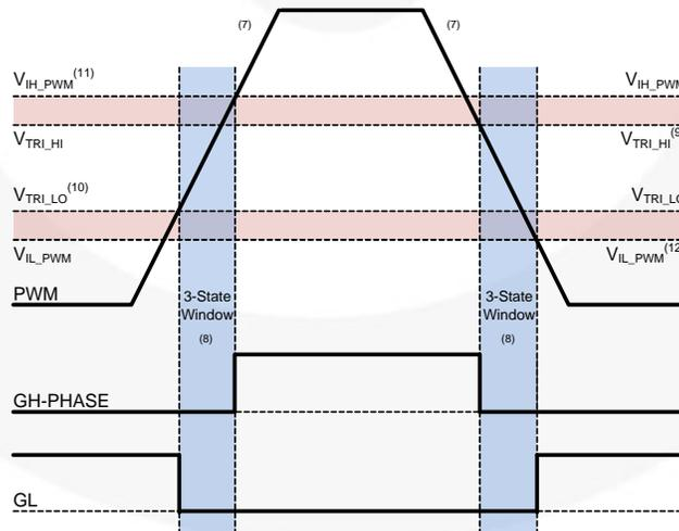
**Figure 28. PWM Threshold Definition**
