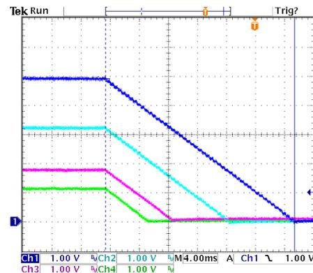
Fig. 9: Simultaneous Soft-Stop
