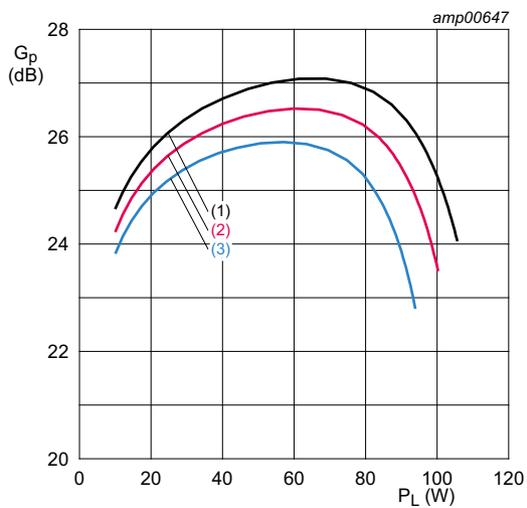
$I_{Dq} = 2 \times 25 + 2 \times 50 \text{ mA}$ ;  $T_{mb} = 25 \text{ }^\circ\text{C}$ ;  $f = 2450 \text{ MHz}$ ;
