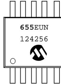
14-Lead SOIC (MCP654)
