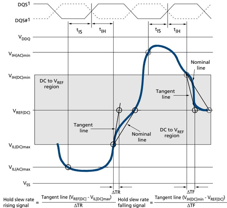
Note: 1. DQS, DQS# signals must be monotonic between  $V_{IL(DC)max}$  and  $V_{IH(DC)min}$ .
