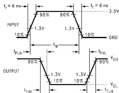
**FIGURE 3. AC Waveforms**
